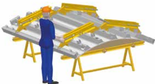
▶ Curvado de paneles sobre plantilla
